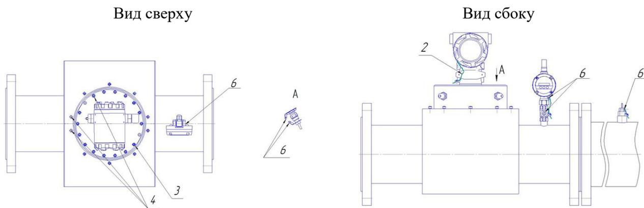
Рисунок 16 – Корпус круглого сечения с защитным кожухом
