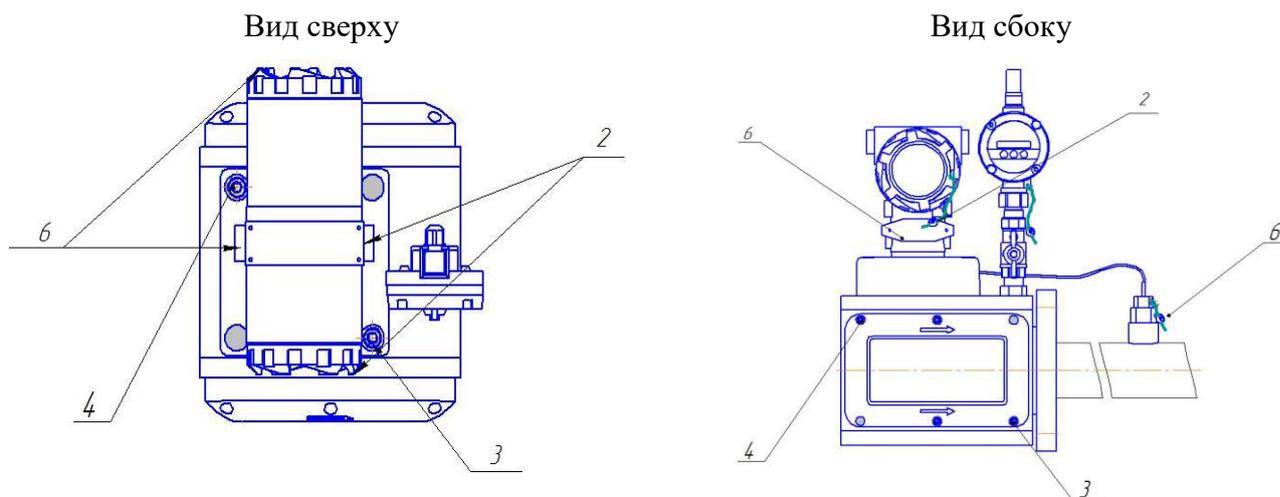
Рисунок 15 – Корпус прямоугольного сечения с совмещенными защитными крышками
