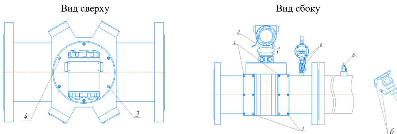
Рисунок 14 – Корпус круглого сечения с отдельными защитными крышками
