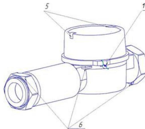
Рисунок 18 – Расходомеры – счетчики газа ультразвуковые Turbo Flow UFG-H
