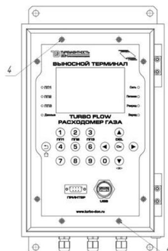
Рисунок 20 – Выносной терминал в металлическом корпусе (ВТМ)
